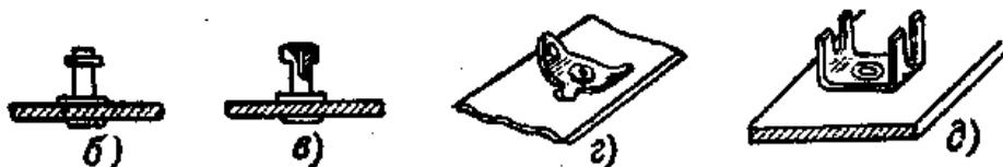
Рис. 8. Конструкция штырьков и лепестков, применяемых на монтажных планках: *a* - штырек с двумя проточками; *б* - штырек с одной проточкой; *в* - штырек с одной проточкой и сквозным отверстием; *г* - лепесток с двумя отверстиями; *д* - лепесток с двумя пазами
