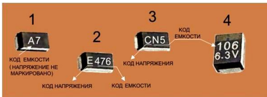
Рис.2 Варианты буквенно-цифровой маркировки SMD конденсаторов
