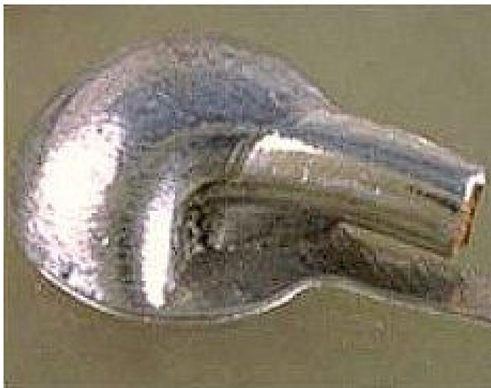
Плохое смачивание припоем вывода компонента.
