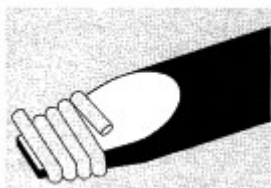
Рис. 2. Облуживание жала паяльника
